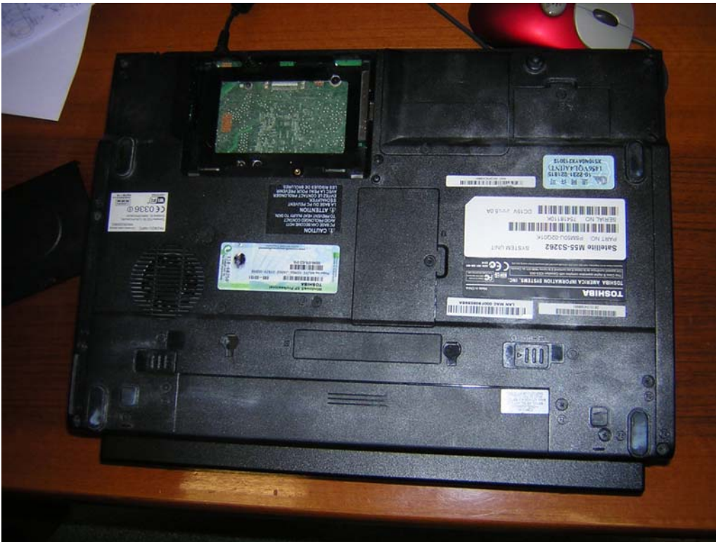
foto n.1-A PC Toshiba, evidenza alloggiamento disco interno
